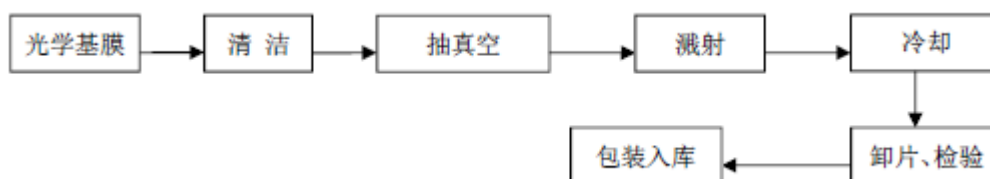
图 3.1-6 光学基膜镀膜生产工艺流程及产污环节图
